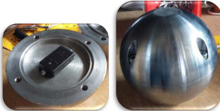
**Bild F.3 — Prüfkugel mit einem im Massenschwerpunkt montierten Beschleunigungsaufnehmer**
